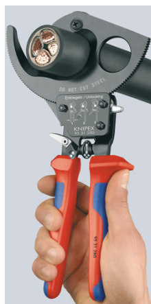
Principe du cliquet et entraînement par couronne dentée à 2 positions pour une coupe moins fatigante
