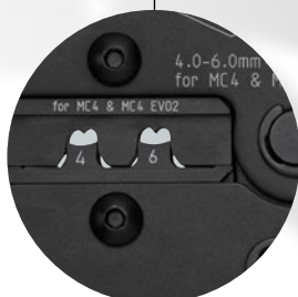
De krimpinzetten voor 4 en 6 mm² krimpen de standaard MC4® en de nog robuustere MC4® EVO 2 connectoren
