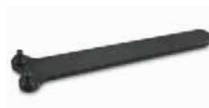
Pengatsleutel voor Ø 3 mm gaten, pen 2,9 mm, afstand 15 mm
