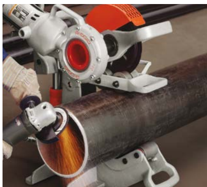
Model 258 met pijpsteun met rollen voor het afschuinen. Geadviseerd wordt om deze handeling met twee medewerkers uit te voeren.
