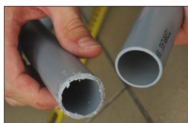
Snede met een ijzerzaag (links) en met de P-TEC 3240 (rechts).
