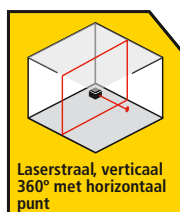
Laserstraal met verticale rotatie van 360°
