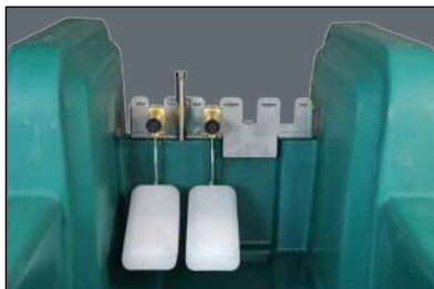
Variante B: 2x MAXIFLOW-Ventil (bis zu 80 l/min!)
