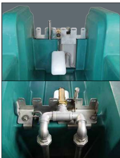
Variante G: 1x MAXIFLOW-Ventil (an Ringleitung) 1x Zusatzheizung 24 V, 180 W
