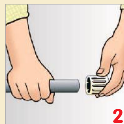
Ebarber intérieurement et extérieurement l'extrémité du tube. Eliminar las rebabas en el interior y en el exterior del tubo.
