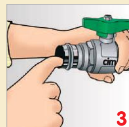
Vérifier que les O-rings d'étanchéité soient correctement positionnés dans leur siège. Il n'est pas nécessaire de les huiler, ni les graisser. Controlar que el O-ring de estanqueidad esté colocado correctamente. No es necesario lubricar.
