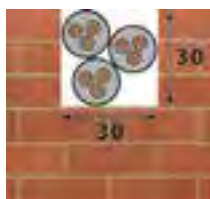
Schlitzten von Kabelkanälen
