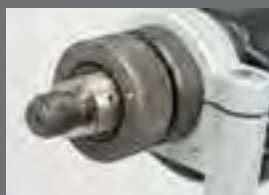
Verstellring für zuschaltbaren Softschlag
