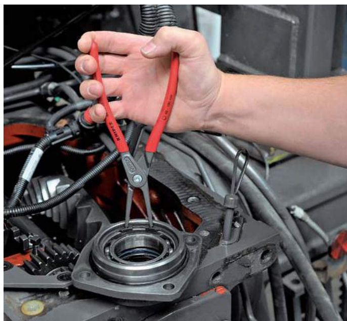
Stabiele ingezette punten van speciaal veredeld verenstaal
