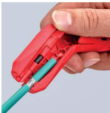
Ontmantelen van een datakabel
