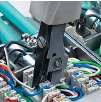
Indrukken en afknippen van de kabel in één beweging
