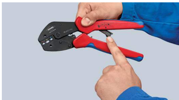
De positioneringspal inklappen en de tang doordrukken – klaar voor de volgende toepassing
