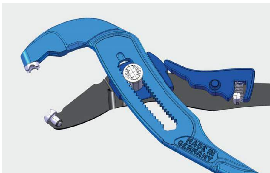
De bevestiging van de veerbandzadelklemmentang maakt eenvoudig en snel werken mogelijk, ook bij gespannen zadelklem. Moderne CAD-techniek simuleert het mechanisme op het beeldscherm.
