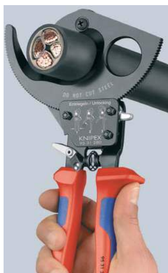
Ratelprincipe en tandkransaandrijving met twee gangen om te snijden met minder kracht
