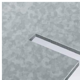
Uitklinken en spaanbreken in één enkele beweging
