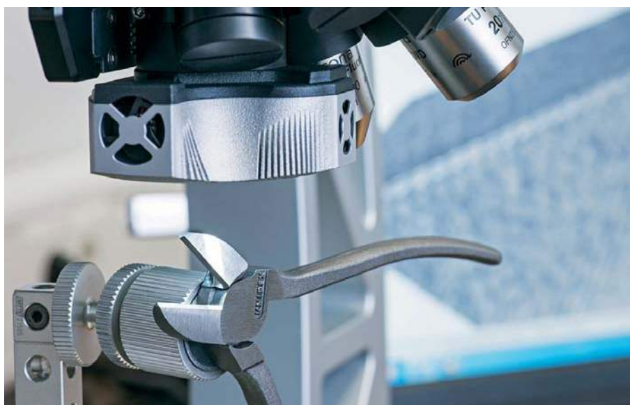
Bij de zijsnijder worden de vorm en de ruwheid van het lemmet met een optisch 3D-meetsysteem precies gemeten.
