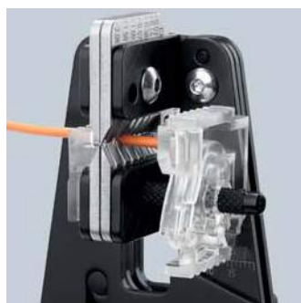
Het rondom nauwkeurig insnijden van de isolatie
