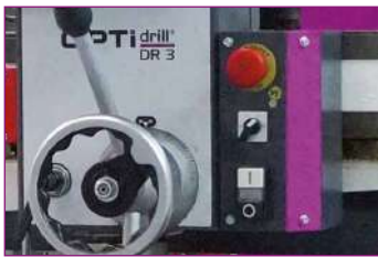
Bedienelemente mit 24 V DC Elektrik
