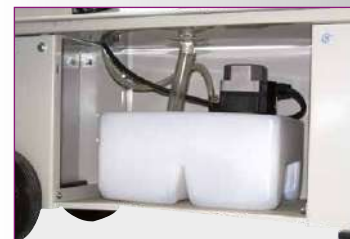
Kühlmitteleinrichtung › Im Unterbau integriert › Behälterinhalt 11 Liter
