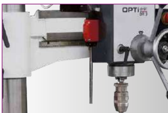
Ausziehbarer Schaltstange > Normgerecht nach DIN 12717
