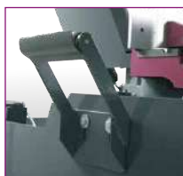
Rollenauflage > Zum Abstützen für lange Materialien
