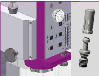
Mechanisches Schnellwechsel-Spannsystem > Fräskopf ist mit einer Spannzange für den Anzugsbolzen BT30x45° ausgerüstet > Leichter Wechsel durch Entriegelung der mechanischen Sicherung und Bewegen des Pinolenhebels nach oben
