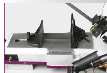
Schnellspannschraubstock › Verstellbare Spannbacken von 0° bis 45° für Gehrungsschnitte
