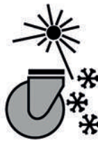
Überlastung durch thermische Einwirkungen
